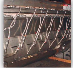
Cabezal y boquillas de inyección de CO2 montados tangencialmente
