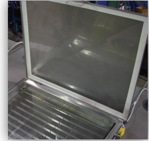
Criba vibratoria neumática extraíble, con cubierta abisagrada
