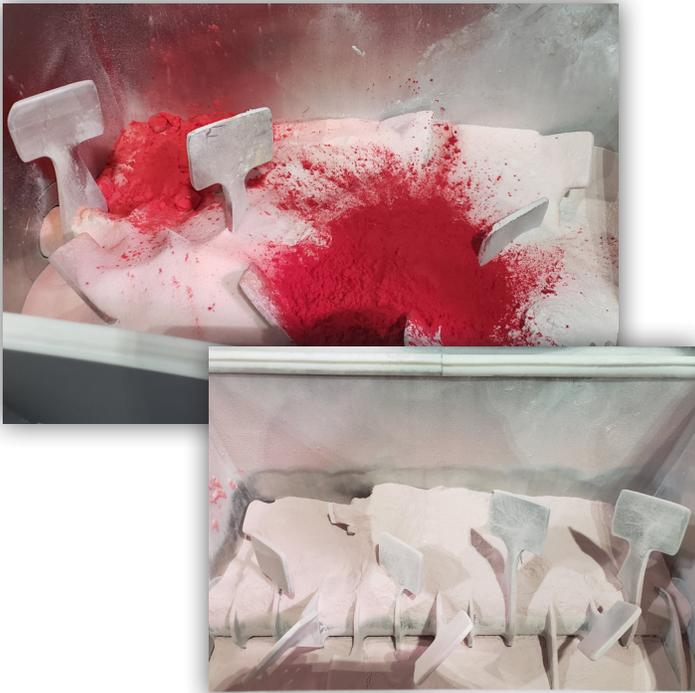
El OptimaBlend® fluidifica el producto, eliminando la segregación de giro causada por la gravedad y asegurando un eficiente y gentil proceso de mezclado independientemente del tamaño de partícula, forma o densidad.
