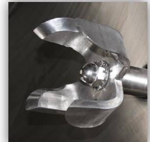
Cabezal de chopper tipo Tulipán para extracción rápida
