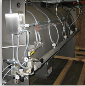
Colector de aire comprimido para sellos y válvula de descarga, y caja de conexiones de acero inoxidable NEMA 4x para componentes monofásicos
