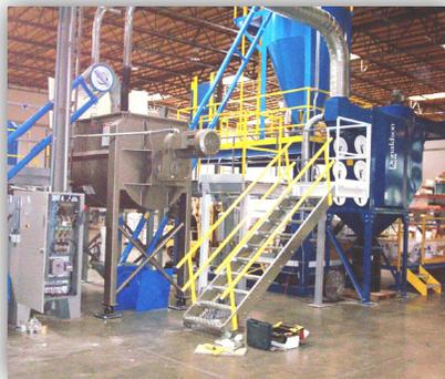
OptimaBlend® FPB-75 para la preparación de materiales para construcción.
