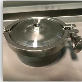
Puerto de adición de líquidos con triple sujeción
