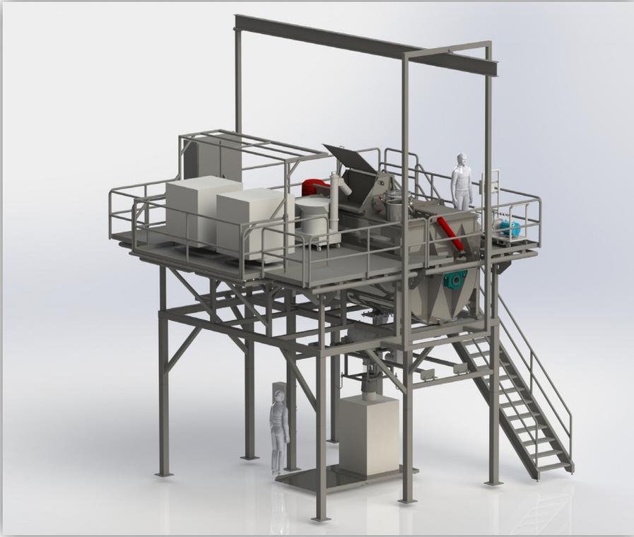
Un ejemplo de la instalación de un Sistema en la industria Nutricional. EIRICH Machines ofrece sistemas llave en mano que incluye: diseño de planta, software, paneles de control, instalación y servicios post-venta. El OptimaBlend®, con equipo auxiliar, puede ser integrado en sistemas pequeños o grandes dependiendo los requerimientos.
