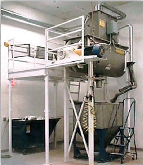
Sistema típico semiautomático con descarga de sacos y mezclador vaciando en contenedor a granel intermedio (CGI). Después del CGI se llevará a operación de empaque.
