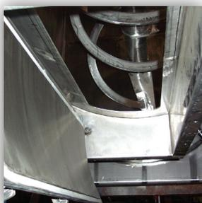
Compuerta de descarga en el fondo
