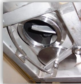
Compuerta de paletas de activación manual
