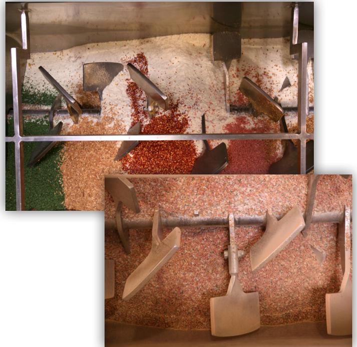
¡El OptimaBlend® es extremadamente gentil con ingredientes frágiles y la fluidificación efectiva asegura mezclados homogéneos sin degradación y en un tiempo muy corto, tan corto como 30 segundos!
