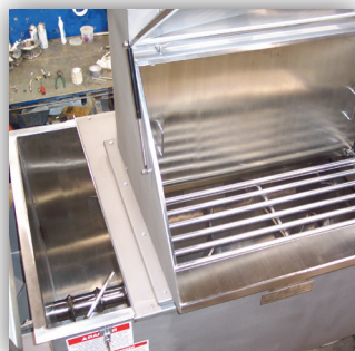
Cubierta de mezcladora a medida de fácil limpieza, con control de polvo
