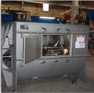
Puertas de acceso laterales
