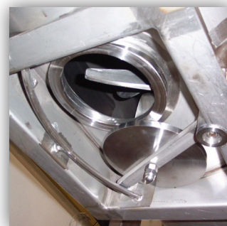
Compuerta de paletas de activación manual
