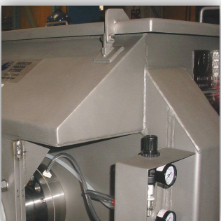
Placas extremas protegidas, para una fácil limpieza
