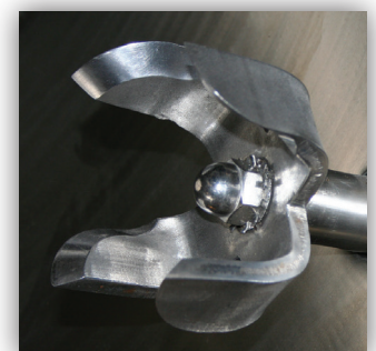
Cabezal picador del tipo de tulipa, diseñado para su extracción externa
