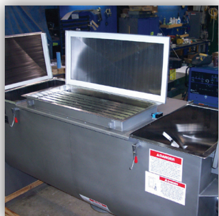
Aberturas de entrada para bolsas a granel con cribas y emparillado magnético
