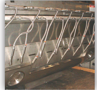
Colector y boquillas de inyección de CO2 de montaje tangencial
