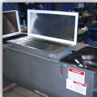
Cubiertas de mezcladora a medida para descarga manual, de fácil limpieza
